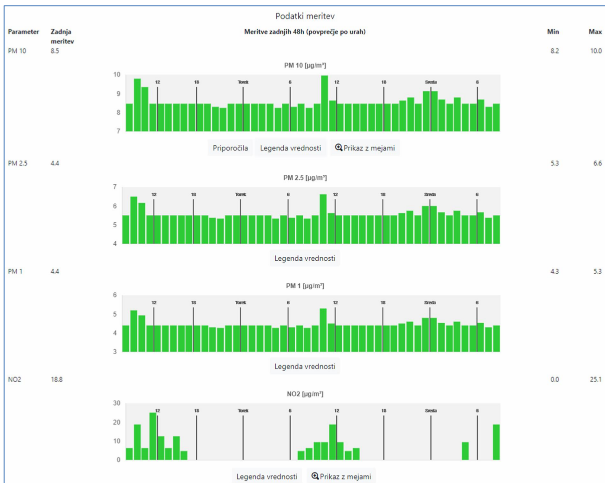
Slika 3: Primer prikaza rezultatov meritev na eni od merilnih postaj za zadnjih 48 ur za parametre PM10, PM2,5, PM1 in NO 2 .
